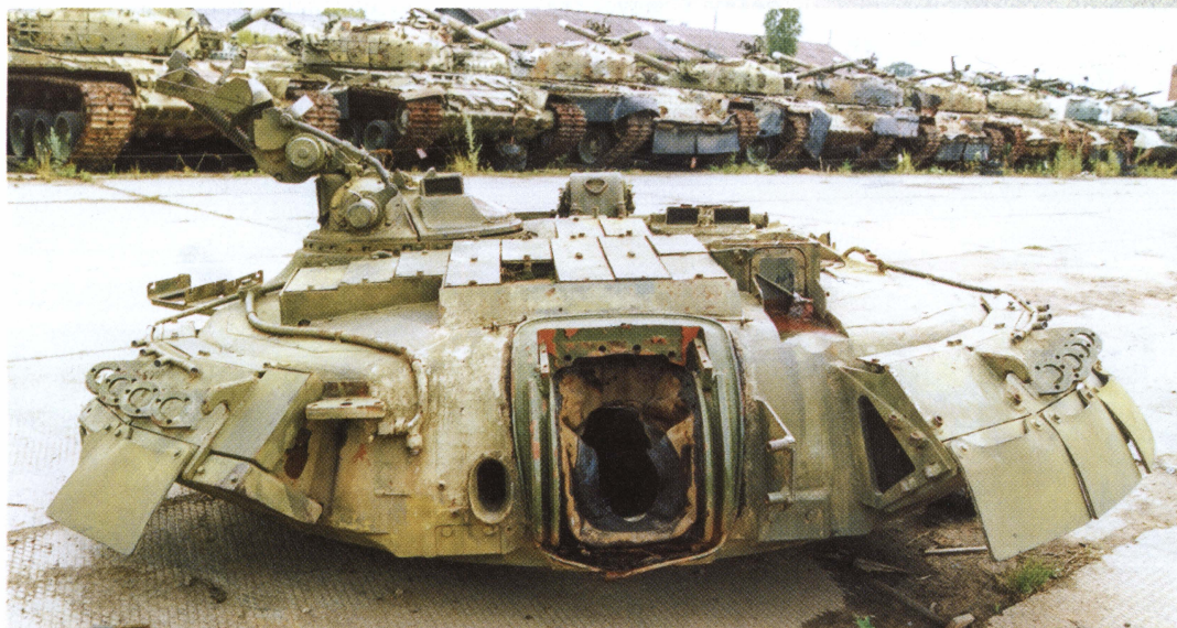
Башня танка Т-80У с демонтированным вооружением. Хорошо видно размещение контейнеров динамической защиты на крыше, а справа — шов броневой заглушки, закрывающей полость с блоками ячеистого наполнителя.
