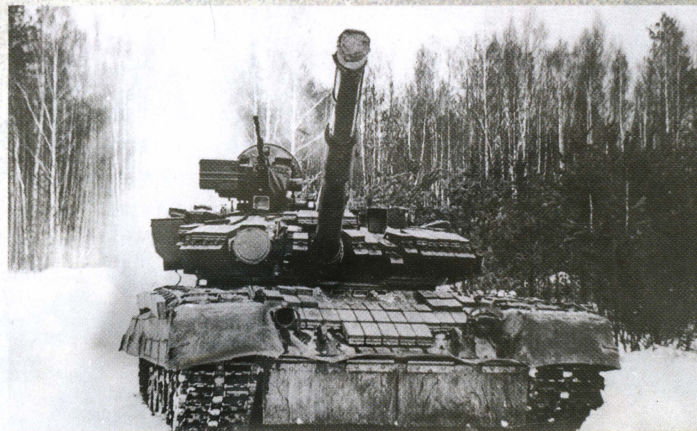
Испытания танка Т-80БВ с навесной динамической защитой «Контакт-1».
